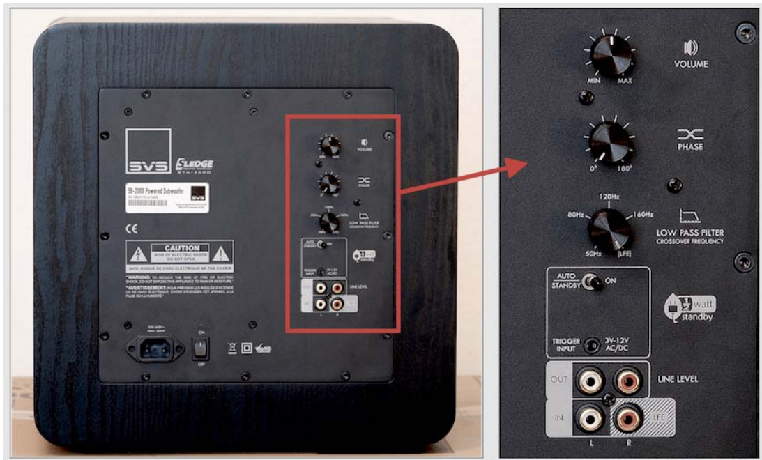
Das Anschlussfeld des SB-2000 ist mit allen Features ausgestattet, die ein aktiver Subwoofer heutzutage mitbringen sollte. Selbst an einen Triggerausgang haben die amerikanischen Soundspezialisten von SVSound gedacht.
