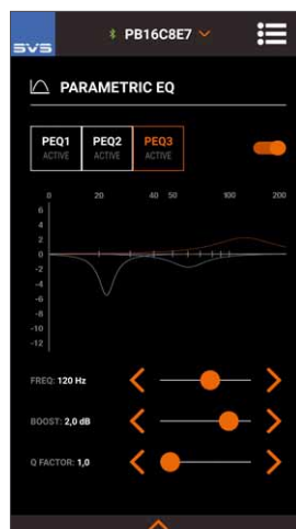
Die drei vollparametrischen Equalizer der SVS-Subwoofer lassen sich komfortabel per Smartphone-App einstellen
