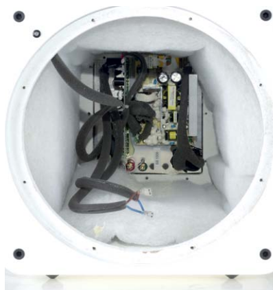
Power im Rücken: Bis zu 700 Watt im Peak stemmt die Endstufe an die Membran.
