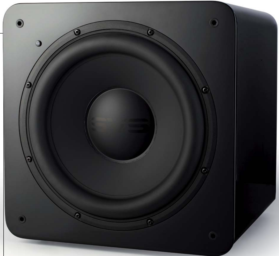
Ü-30-PARTY: Der 12-Zöller (30,5 cm) mit Alukorb, Doppelmagnet und Polypropylen-Membran verarbeitet die 500 Watt Sinus seiner Endstufe mit doppelten Schwingspulen. Sicke und Zentrierspinne wurden für langes Leben und langen, linearen Hub optimiert.
